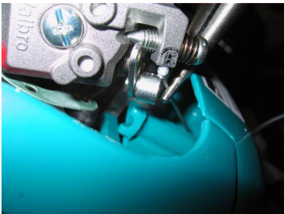
Gaskabel monteres i karburator, luftfilterdæksel skrues fast.
