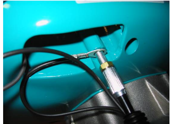
Kabel og stelledning skrues på
