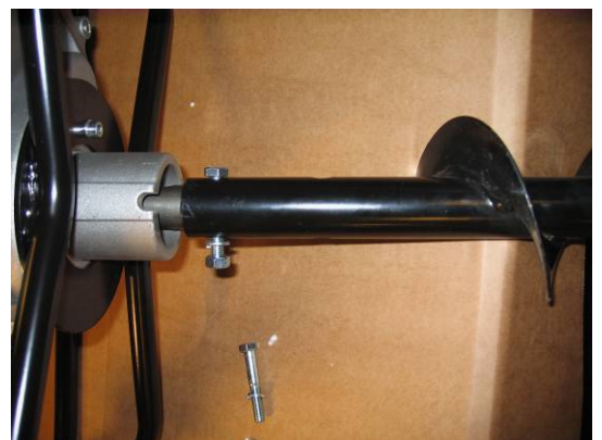
Jordboret monteres og spændes med 8 mm skruer.
