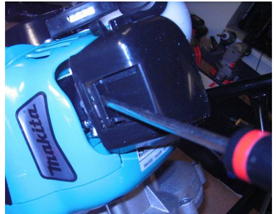
Luftfilterskjoldet clippes fri og åbnes.
